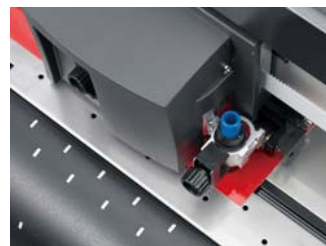
Положение ножа в каретке при сквозной резке
