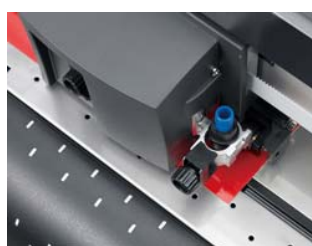
Положение ножа в каретке при стандартной резке
