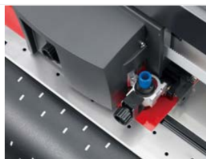
Положение ножа в каретке при сквозной резке лекал
