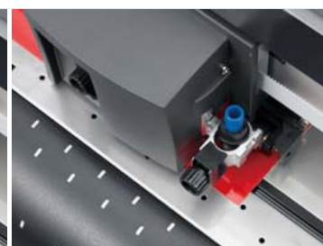
Положение ножа в каретке при стандартной резке
