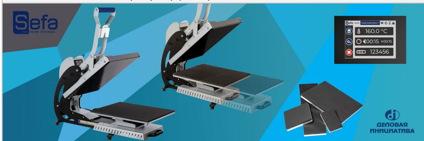
Термотрансферный пресс Clam PRO: размер плиты 40x50 см, прижим плиты ручной, подъем плиты автоматический – электромагниты, стол выдвигается вперед вручную, электронная сенсорная панель управления, программирование настроек, ресурс работы нагревательного элемента минимум 10 лет, плавная регулировка давления плиты, давление плиты 330 г\см.кв, вес 58 кг, мощность 3200 Вт, габариты 969x990x453 мм, про-во Sefa (Франция)
