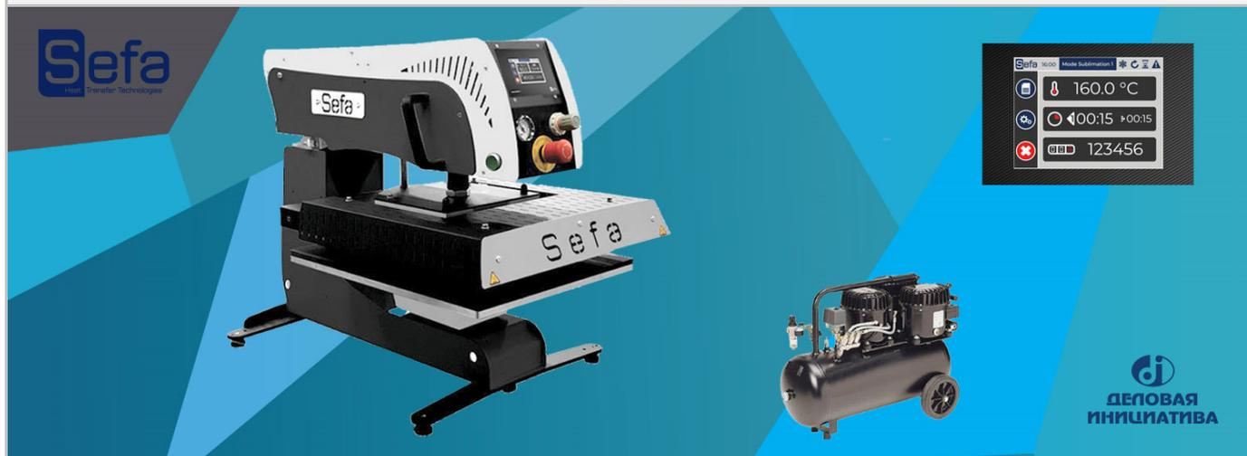
Профессиональная серия термотрансферных прессов: размер плиты 40x50 см, прижим плиты гидравлический, подъем плиты автоматический, верхняя плита отворачивается в сторону в ручную Rotex AIR LITE или автоматически Rotex AIR PRO, электронная сенсорная панель управления, программирование настроек, ресурс работы нагревательного элемента минимум 10 лет, давление плиты 400 г\см.кв, вес 81 кг, габариты 621x847x572 мм, про-во Sefa (Франция)
