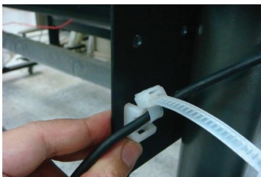
**Шаг 3** Вставить конец хомута с кабелем в нижнее отверстие кронштейна.
