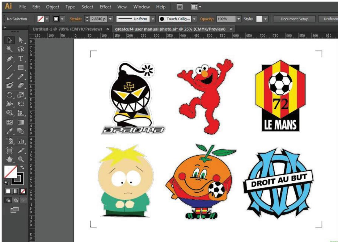
**Шаг 3** Выбрать объект целиком, включая приводочные метки и линию контура, и выполнить File > GreatCut > Cut.
