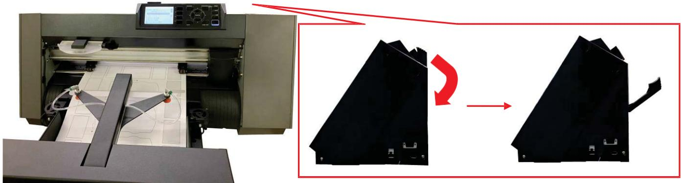
2. Вытяните кончик материала к передней части прижимного ролика плоттера CE7000-40.
