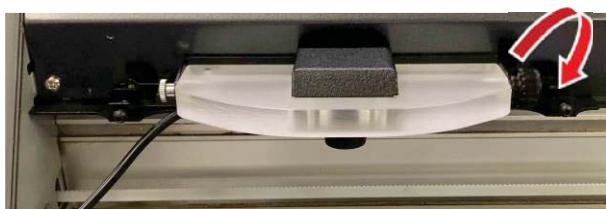
3. Отрегулируйте угол наклона камеры так, чтобы паз на передней крышке CE7000 совпадал с контрольными линиями, отображаемыми в программном обеспечении iMark Plus, как показано на рисунке.
