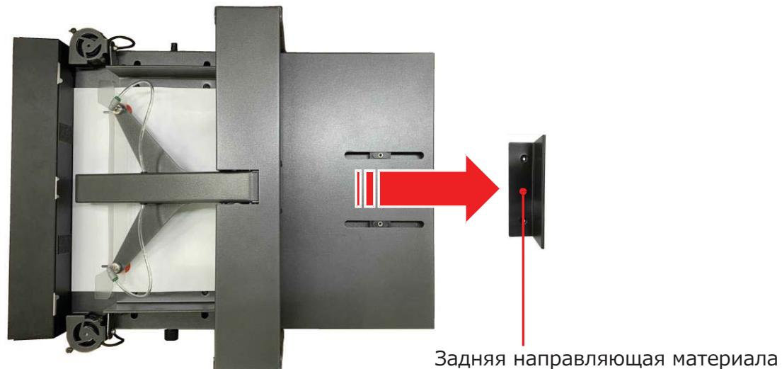
4. Установите удлинительную пластину на F-Mark2.
