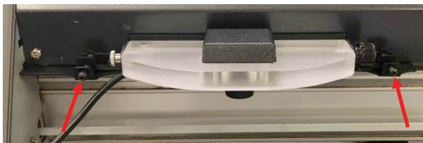
8. Снимите крышку с объектива камеры.
