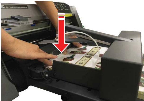
4. При использовании вентиляторов отрегулируйте скорость их вращения и ширину боковой направляющей материала так, чтобы лист слегка приподнимался.
